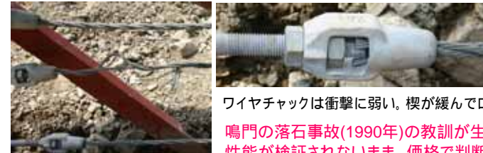
端末支柱のウェブが局部破壊
